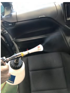
トルネーダータイプのエアガンを使用 使用量目安：100mlで約車1台分
